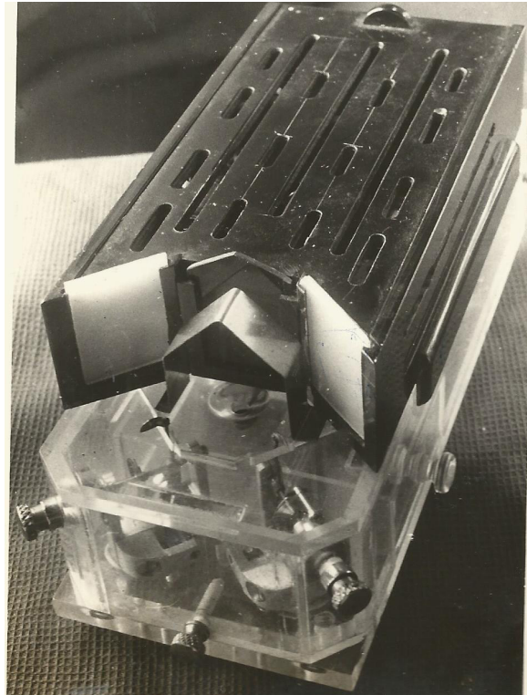
Figura 15. Aspectos externos do aparelho da Figura 12 após a substituição dos visores (“olhos de boi”) por “janelas” planas, de material plástico branco-leitoso, translúcido. Vê-se entre as “janelas” (SD e SΔ) o arco em forma de cumeeira, empregado para acelerar a modelagem da pressão-à-alavanca. O arco impede giros em torno dos operanda e torna mais provável o acesso ao bebedouro mediante a passagem sobre as alavancas (Pessotti, 1967d).
